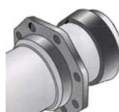
Dans le cas du tuyau BP, on remplace l'élément existant de 7 m par deux tronçons en BP âme- tôle bridés. La vanne est installée moyennant un JD autobuté.
