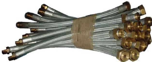
Flexibles de raccordement constitués par un tuyau en élastomère, assurant la fonction « étanchéité », autour duquel est tressé une gaine en acier inoxydable assurant la fonction «résistance à la pression ». Ils comportent à chaque extrémité un raccord permettant d'effectuer leur assemblage avec d'autres éléments du réseau.
