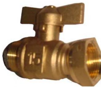
Le robinet droit en laiton 1/4 tour EP3/4"- M3/4" est assemblé au compteur à l'aide d'un écrou prisonnier ; l'étanchéité est assurée par un joint en fibre
