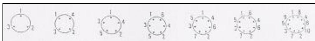
Après les essais hydrauliques, il est impératif de vérifier le serrage des boulons et de les resserrer le cas échéant.
