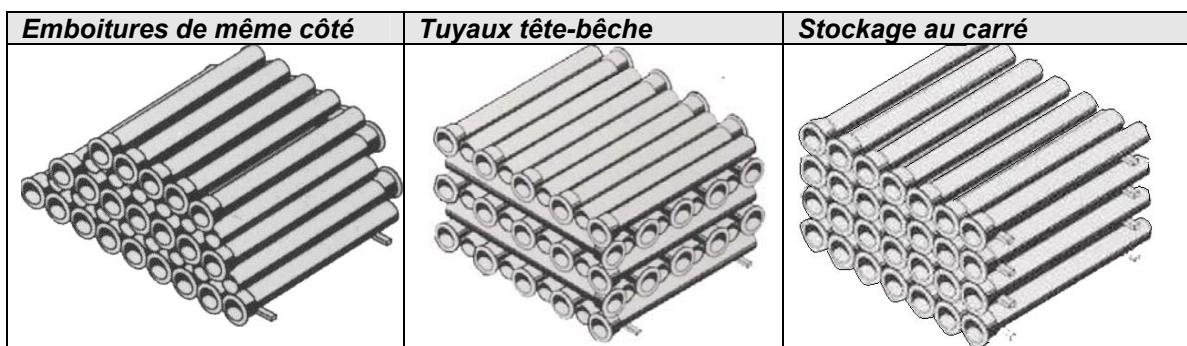
L'endroit retenu pour le stockage des tuyaux est consistant, aussi plat que possible et exempt de pierres, roches ou corps durs susceptibles de blesser les tuyaux et d'entrailler leur revêtement.
