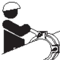
d. Vérifier la position de la contrebride, puis serrer les écrous à la clé en opérant dans l'ordre des numéros figurant sur le schéma ci-dessous :
