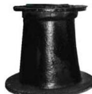
Bouche à clé en FD de face apparente ronde, pèse 6kg, enduite de peinture hydrosoluble noire non toxique, son diamètre d'embase est de 220 mm avec ouverture de 120 mm pour permettre l'insertion d'un tube allonge en PVC Ø110 mm.
