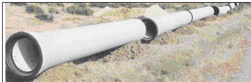
Les tuyaux seront calés sur deux lits de pose stables en terre meuble ou tamisée afin que les tulipes ne soient pas en contact avec le sol.
