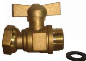
EP $\frac{3}{4}$  " - M $\frac{3}{4}$  " et EP1" - M1". L'étanchéité extérieure est réalisée par joint torique, l'étanchéité interne est réalisée par siège en Téflon.
