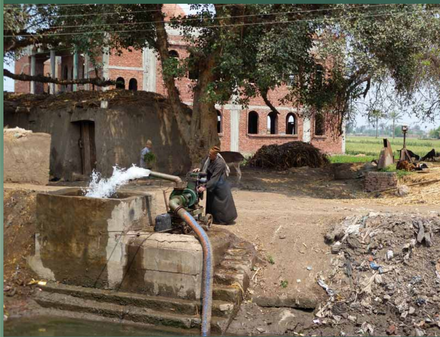
La motopompe a détrôné la saqiya pour remonter l'eau vers les champs. Symbolique, cette photo montre la saqiya abandonnée en arrière-plan.
