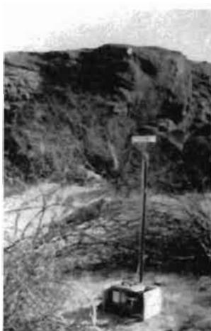
Fig. 199. Pluviographe Filotecnica installé dans la nature et protégé par une " zériba " (Afollé-Mauritanie)
