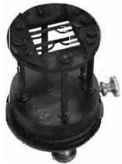
Fig. 51. Pyrhéliomètre d'Angström (A. Lindblad Stockholm)
